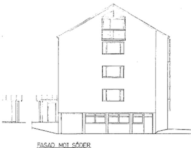
Bygglövs vid inglasningen 1993. Bilden visar att balkongerna endast marginellt sticker ut utanför den ursprungliga skärmväggen.
