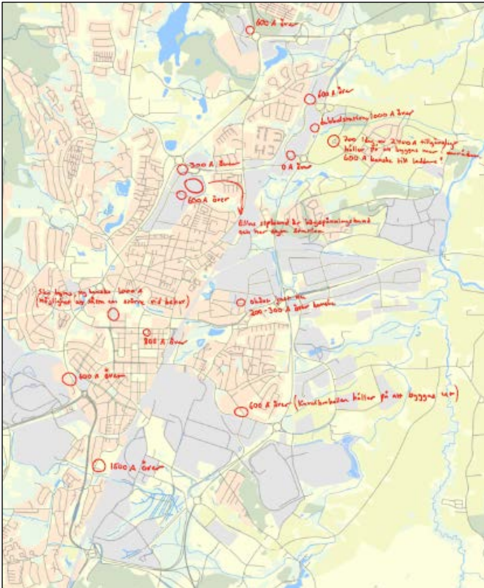
Figur 3. Transformatorstationer och deras lägen, samt hur mycket tillgänglig strömcapacitet (A) som finns. (Skövde Energi)
