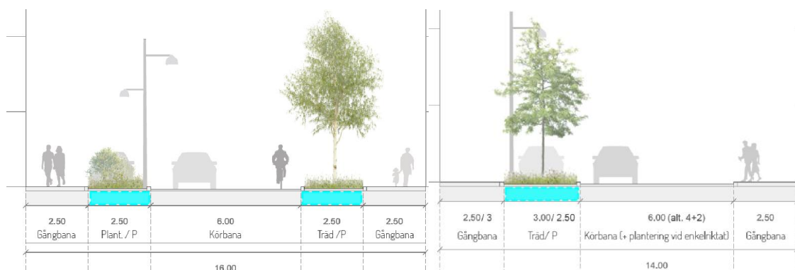
Figur 13. Principsektion: Matargata 0,4 m 3 /lm. Figur 14. Principsektion: Lokalgata 0,2 m 3 /lm. (Källa: Gestaltningsprogram 2023).
