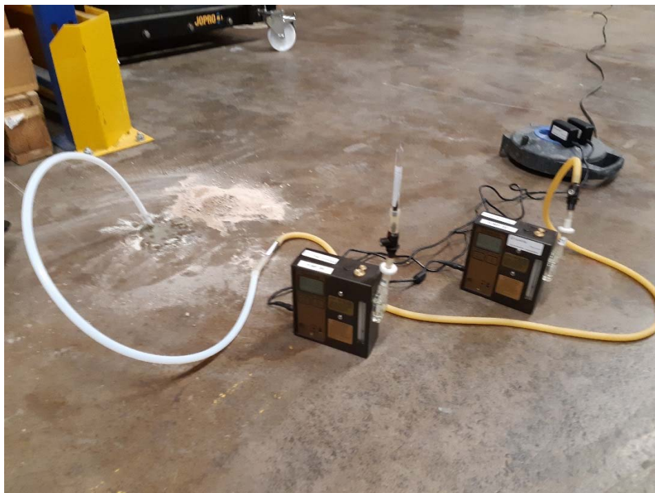
Figur 11. Provtagningsutrustning för inomhusluft och porgas. Pump för mätning av inomhusluft placerades invid porgaspumpen på intilliggande hylla för provtagning ca 1,2 m över golvet.
