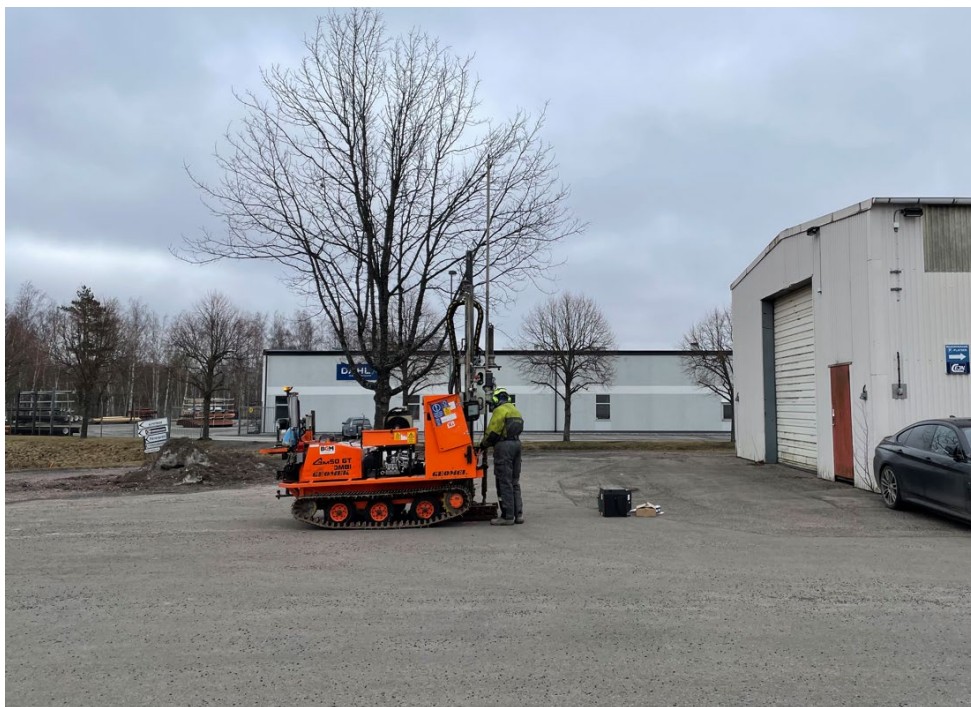
Figur 13. Foto taget 2024-03-06. Skruvprovtagning i provpunkt 24M002.
