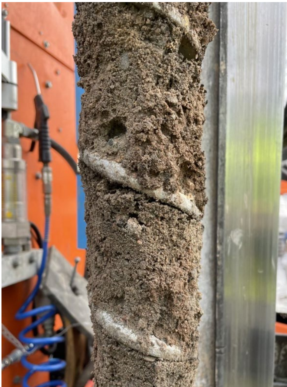
Figur 15. Foto taget 2024-03-07. Fyllning av sand och grus (provpunkt 24M008, 0–0,9 m).
