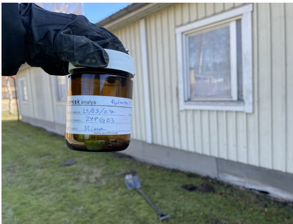
Figur 14. Foto taget 2024-03-07. Provtagning med spade av ytlig jord för PCB-analys.
