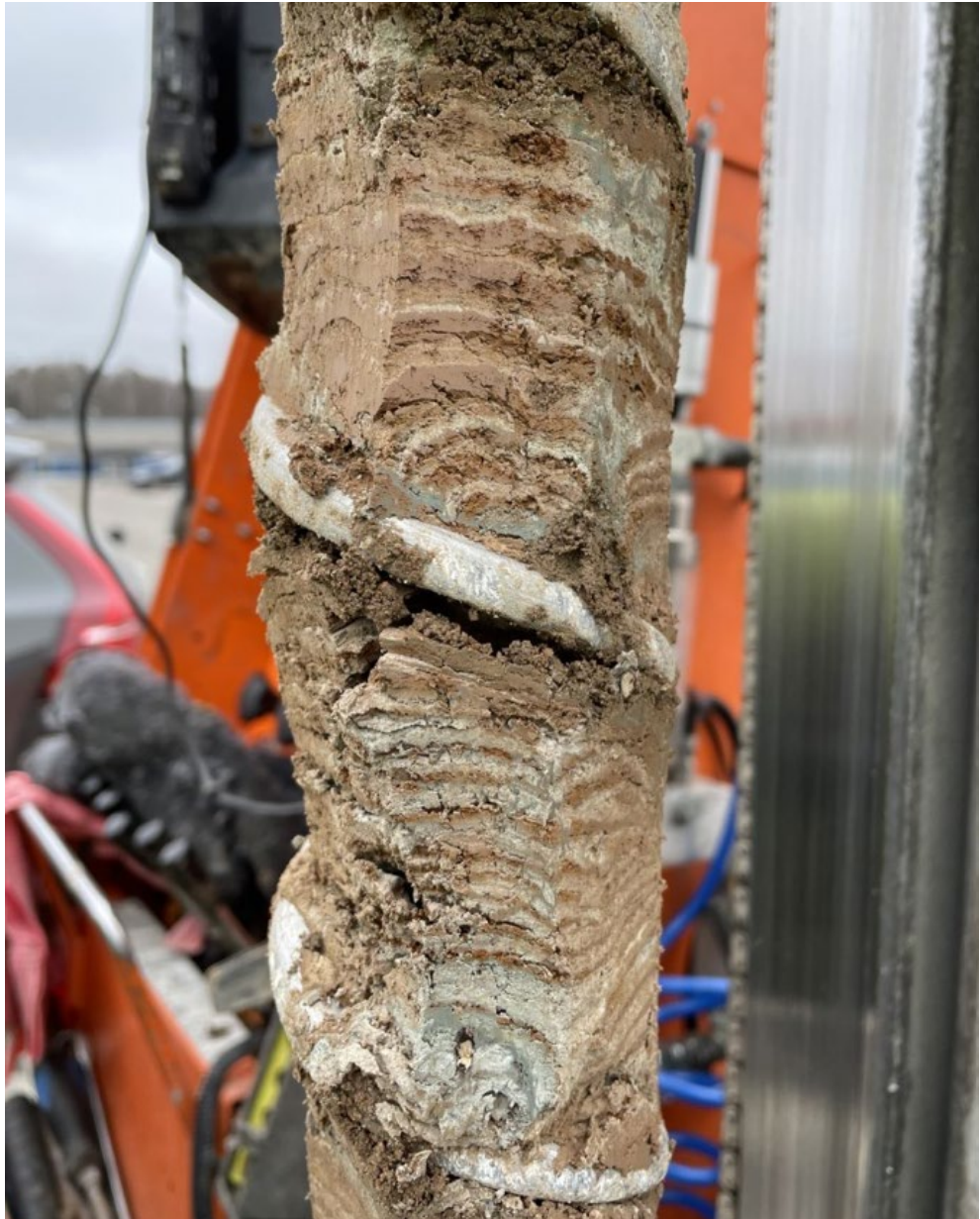
Figur 16. Foto taget 2024-03-07. Naturlig jord av varig torrskorpelera med siltskikt (provpunkt 24M003, 1,0–1,6 m).
