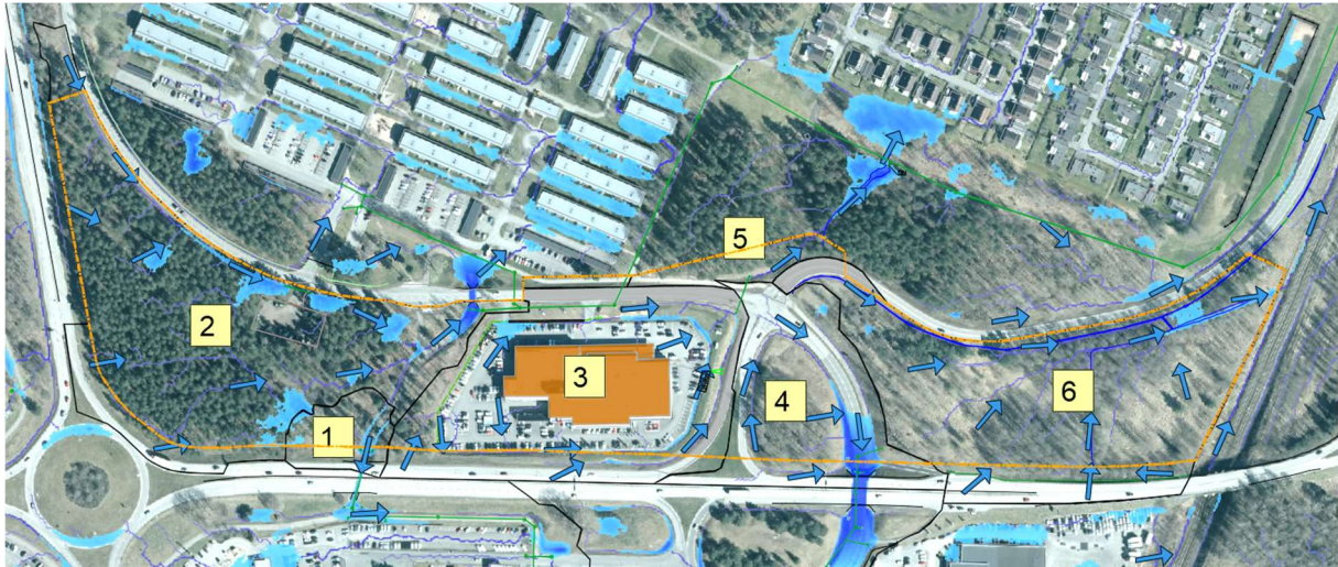
Bild 19: Översikt över all mark (13,1 ha) som har sin skyfallsavrinning via detaljplaneområdet idag. 45 mm regn, bearbetat utdrag ur SCALGO Live, visar översvämmade ytor, avrinningsvägar och avrinningsområde vid skyfall.
