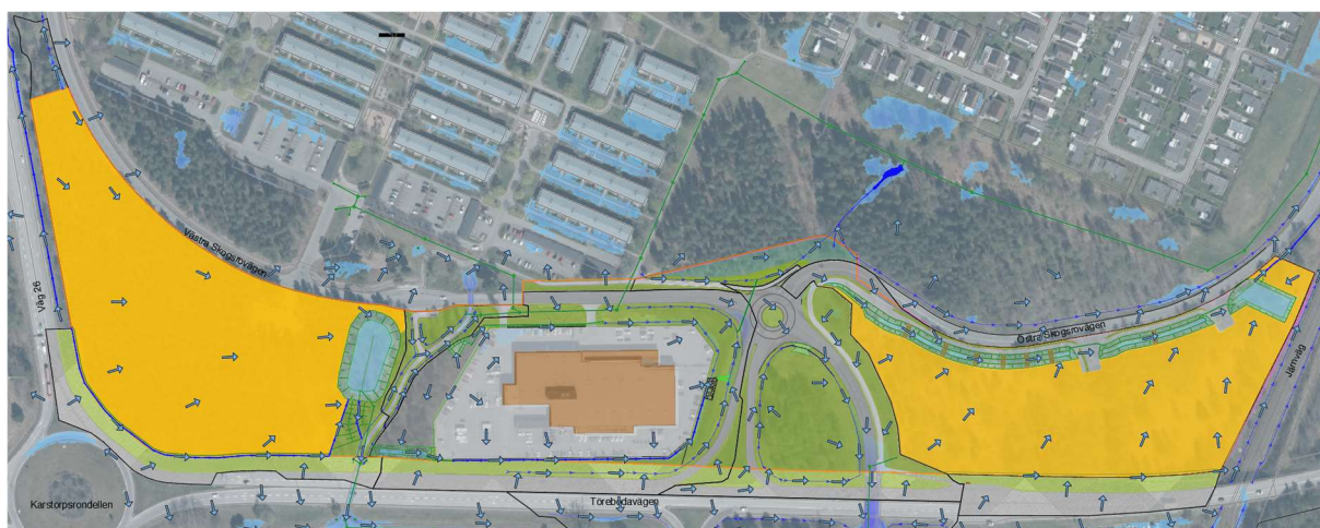
Bild 24: Skyfallsavrinning via detaljplaneområdet efter exploatering. 100 års regn, 62 mm regn, bearbetat utdrag ur SCALGO Live, visar översvämmade ytor och avrinningsområde vid skyfall.
