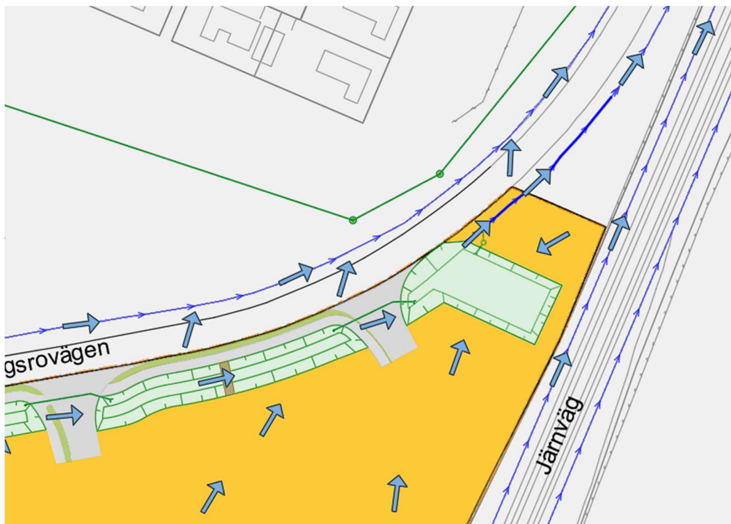
Bild 30: Skyfallsavledning östra delen av området.
