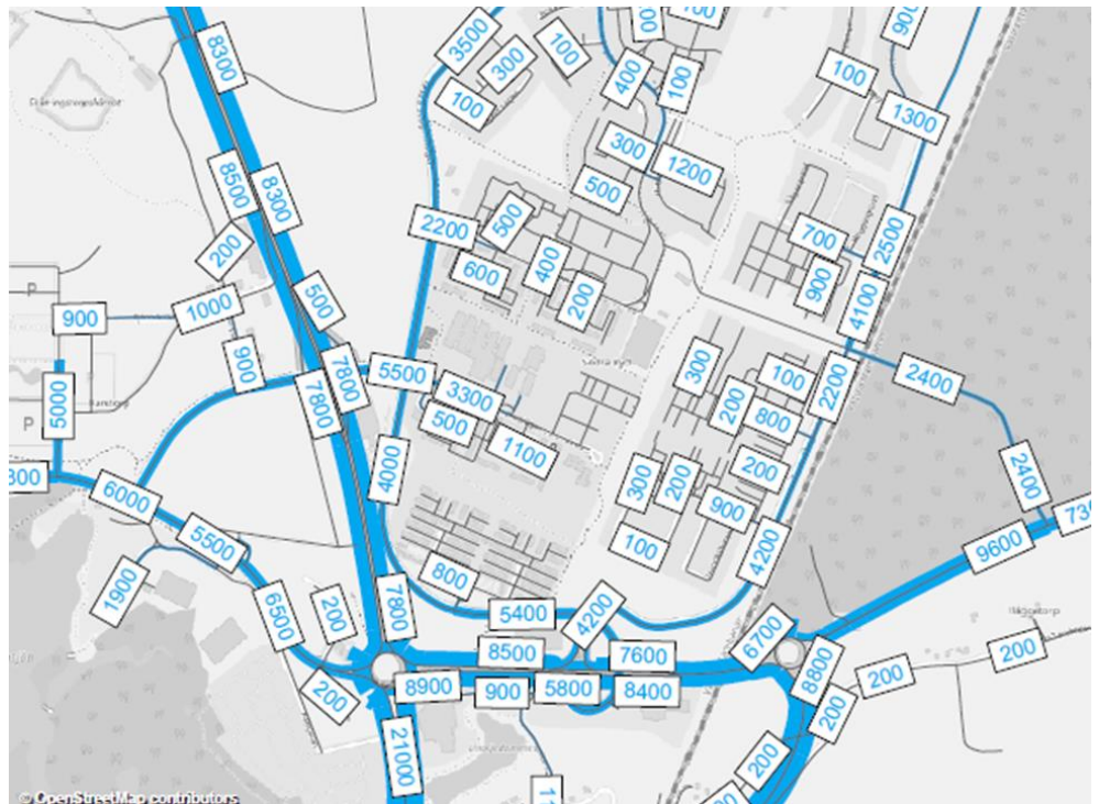
Figur 10 Prognosticerade trafikflöden år 2040 enligt alternativ 1a i den övergripande trafikanalysen, siffror anger fordon/dygn som ÅMVD (årsmedelvardagsdygnstrafik). (Källa: Ramböll, 2018).
