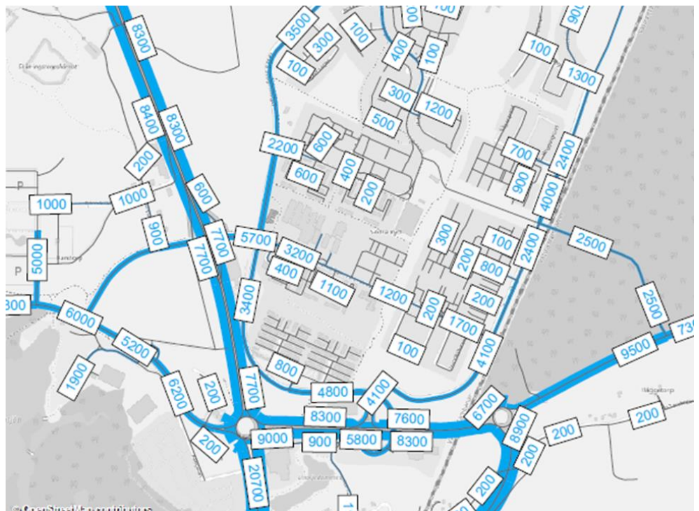
Figur 11 Prognosticerade trafikflöden år 2040 enligt alternativ 1b i den övergripande trafikanalysen, siffror anger fordon/dygn som ÅMVD (årsmedelvardagsdygnstrafik). (Källa: Ramböll, 2018).
