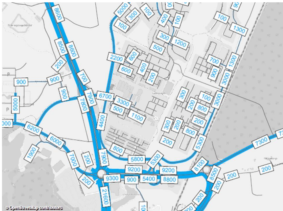
Figur 9 Prognosticerade trafikflöden år 2040 enligt nollalternativet i den övergripande trafikanalysen, siffror anger fordon/dygn som ÅMVD (årsmedelvardagsdygnstrafik). (Källa: Ramböll, 2018).
