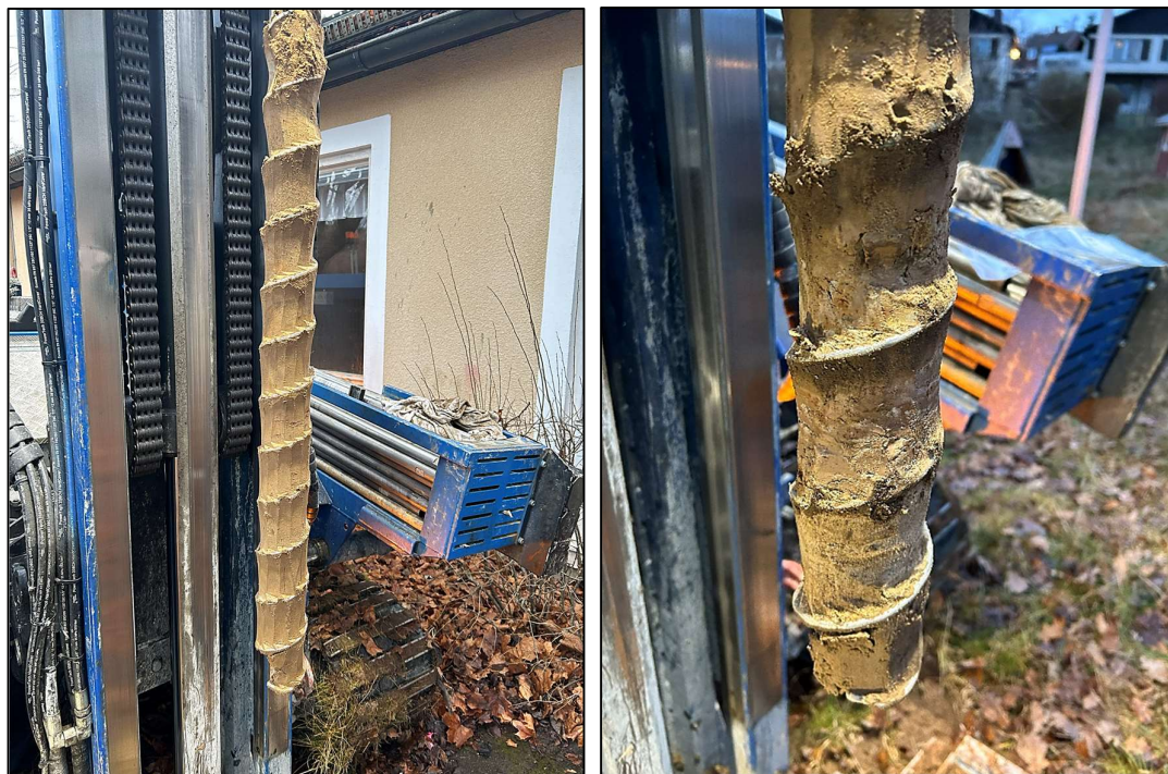
Figur 8. Bild 1: Skruv från 25AF01 2-2,5, materialet utgörs huvudsakligen av sand. Bild 2: längst ner på skruv 25AF06 på djup 2,7-3, inslag av lera i sanden.
