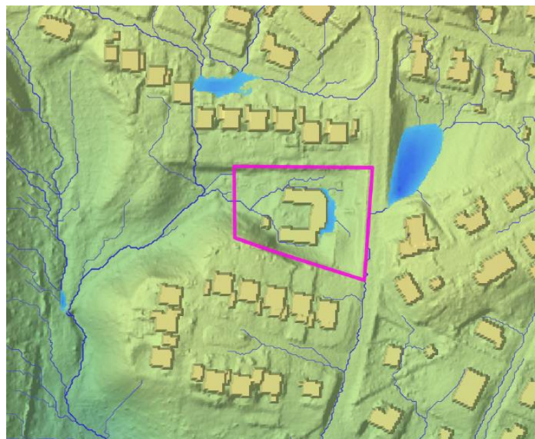
Figur 8. Befintlig situation vid ett 100-årsregn.
