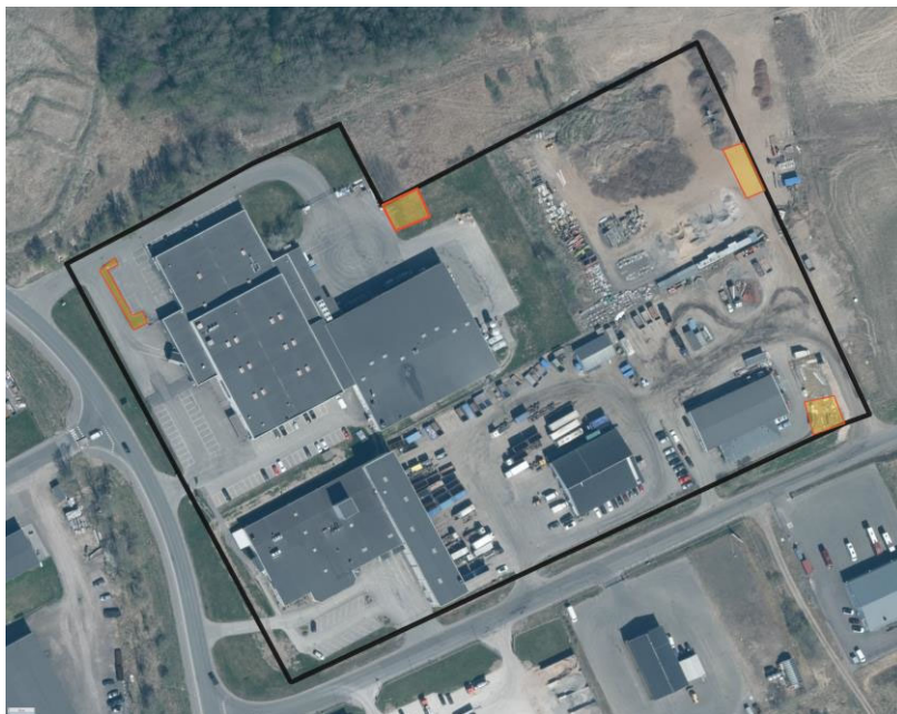
Bilden visar föreslagna ytor för dagvattenfördröjning inom planområdet. Hämtat ur dagvattenutredning.
