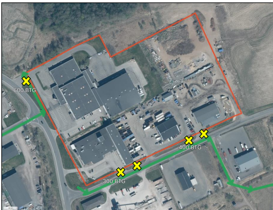
Figur 4. Sträckning av befintligt dagvattennät. Anslutningspunkter är markerade med gula kryss.
