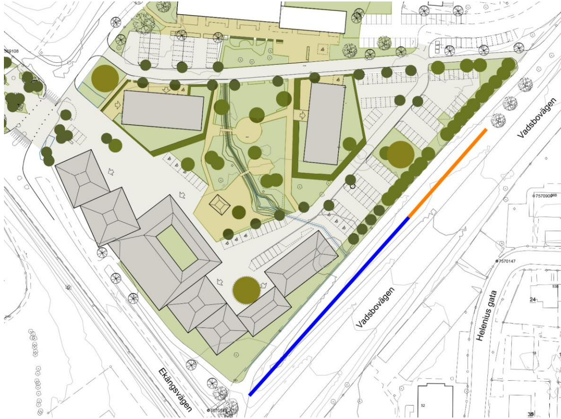
Figur 3. Blå markering indikerar befintlig bullervall. Orange markering indikerar förlängning av bullervall.
