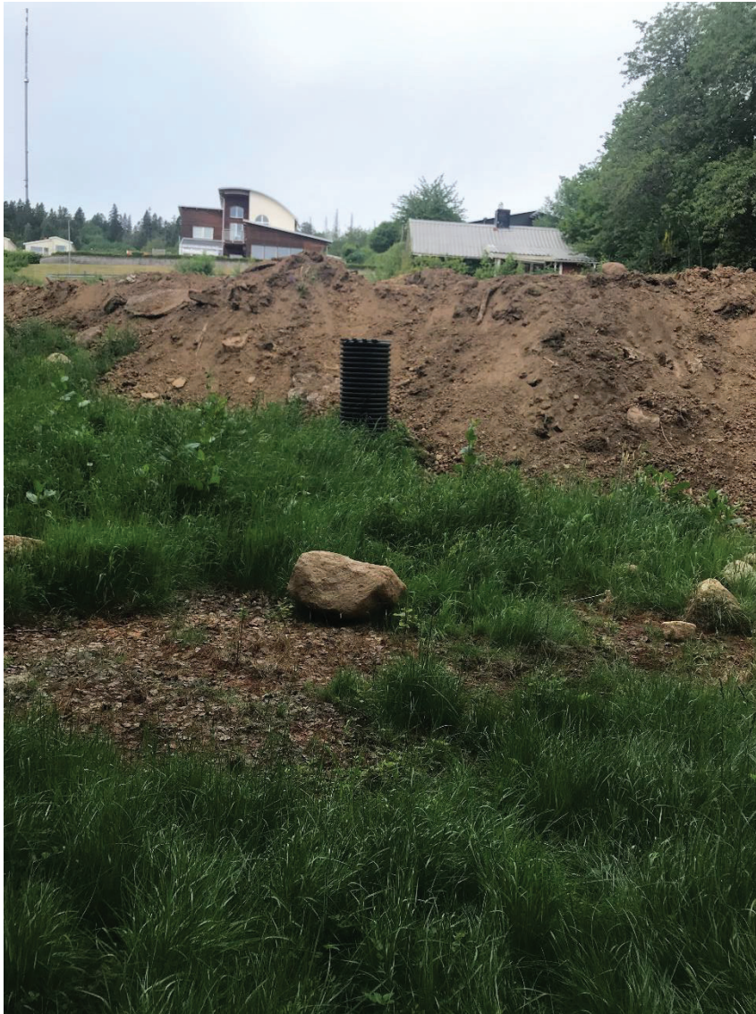
Figur 17. Bild 11. Vy åt nordväst, i bakgrunden syns villor som ligger väster om Lerdalavägen. Mitt i bild syns brunnen som står mitt på befintligt fastighet (Skövde 4:101). I brunnen bedöms vatten stå ca 0,5 m under marken. I förgrunden syns botten av sänkan som bildas av den gamla vägen. Vid besöksstillfället känns marken fuktig men inte blöt.
