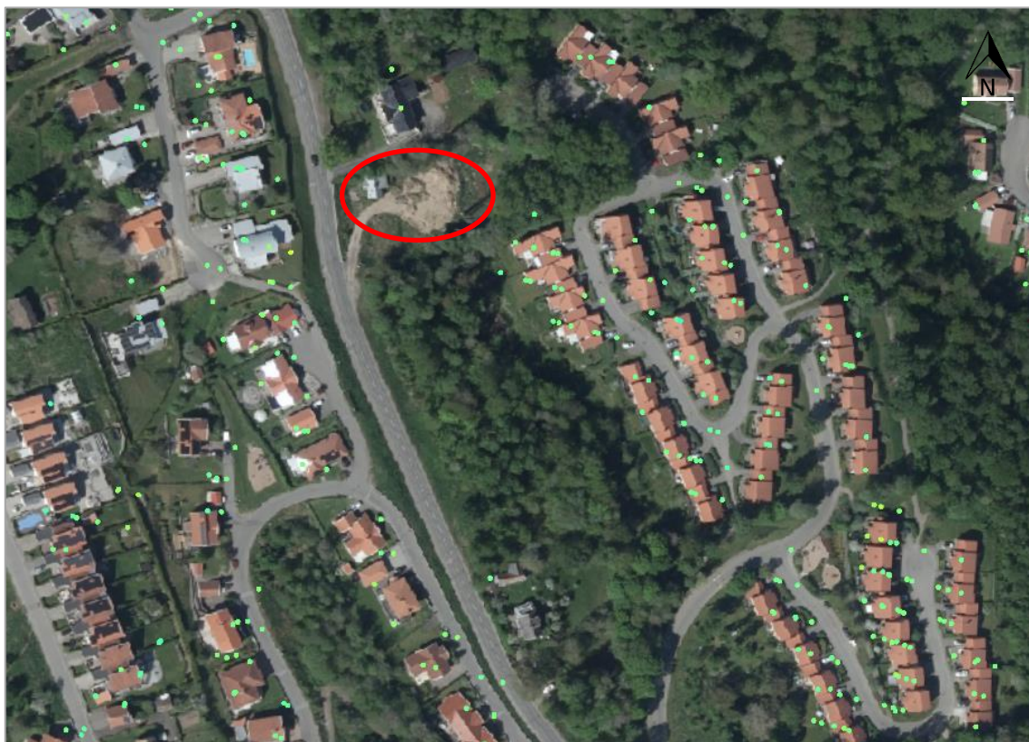
Figur 3. InSAR-mätningar för omgivande fastigheter. Röd markering visar utlagda fyllnadsmassor intill en villa som planeras att rivas.
