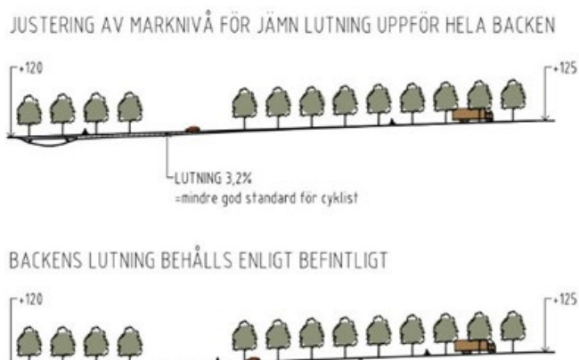
Figur 29 - Bilden nedan är marksektioner som illustrerar den befintliga sluttningen för den västliga kopplingen upp på Motorblocket.
