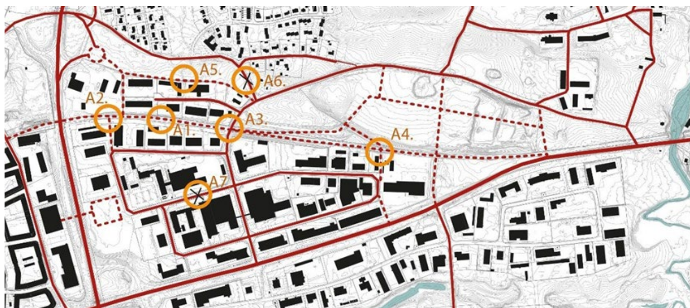
Figur 16 - Tänkbara punkter och stråk för inre kopplingar inom befintligt verksamhetsområde för ökad kapacitet och robusthet av vägnätet.
