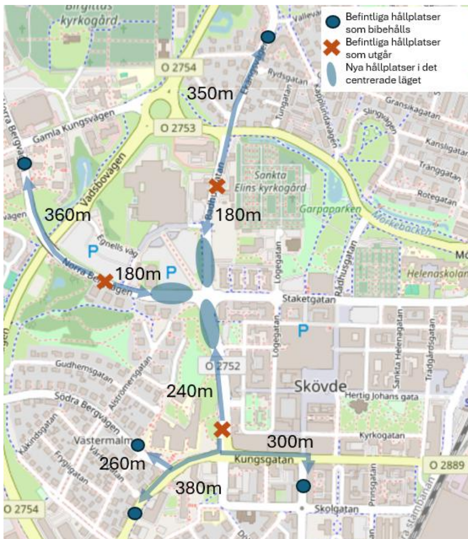
Figur 4-8 Påverkan på infrastruktur för buss, samt sträcka till nytt hållplatsläge. Röda kryss är befintliga hållplatslägen som föreslås tas bort till förmån för centrerad hållplats. Blå ring är befintliga hållplatser som bibehålls och blåa ovaler är förslag till ny placering av hållplatslägen.
