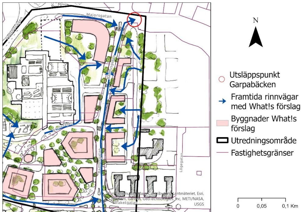
Figur 7. Inzoomad bild på de nya rinnvägarna baserat på What!s förslag på byggnation (2025) med fokus på östra delen av utredningsområdet. (Tyréns, 2026)
