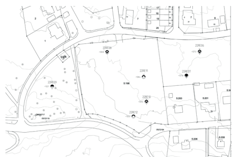
Marknivåerna lutar från +132 i väst till +123.5 i öst. Bilden visar västra området.
