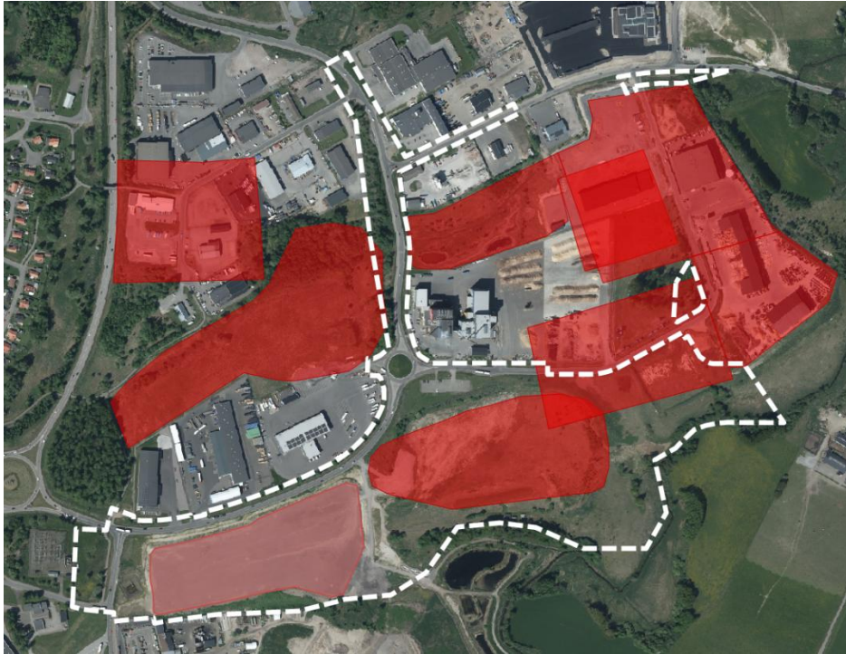
Figur 6. Rosa yta i sydväst markerar område där rödfyrmassor deponerats. Röda ytor markerar områden med formsanddeponi (sotsand) (Mitta, 2023).
