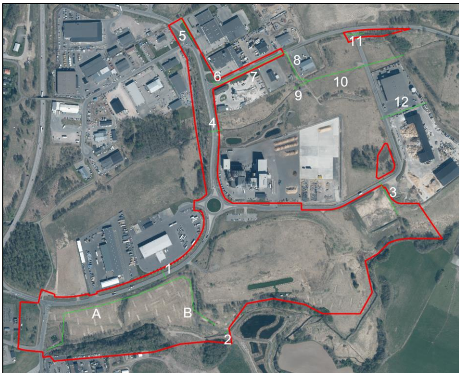
Figur 9. Dragning av dagvattennät inom och i anslutning till planområdet.
