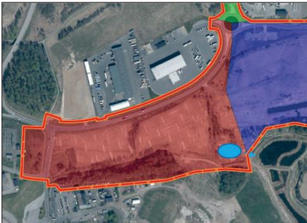
Figur 4. Föreslagen dagvattendamm med anslutningspunkt för utlopp redovisat (Sweco, 2024).
