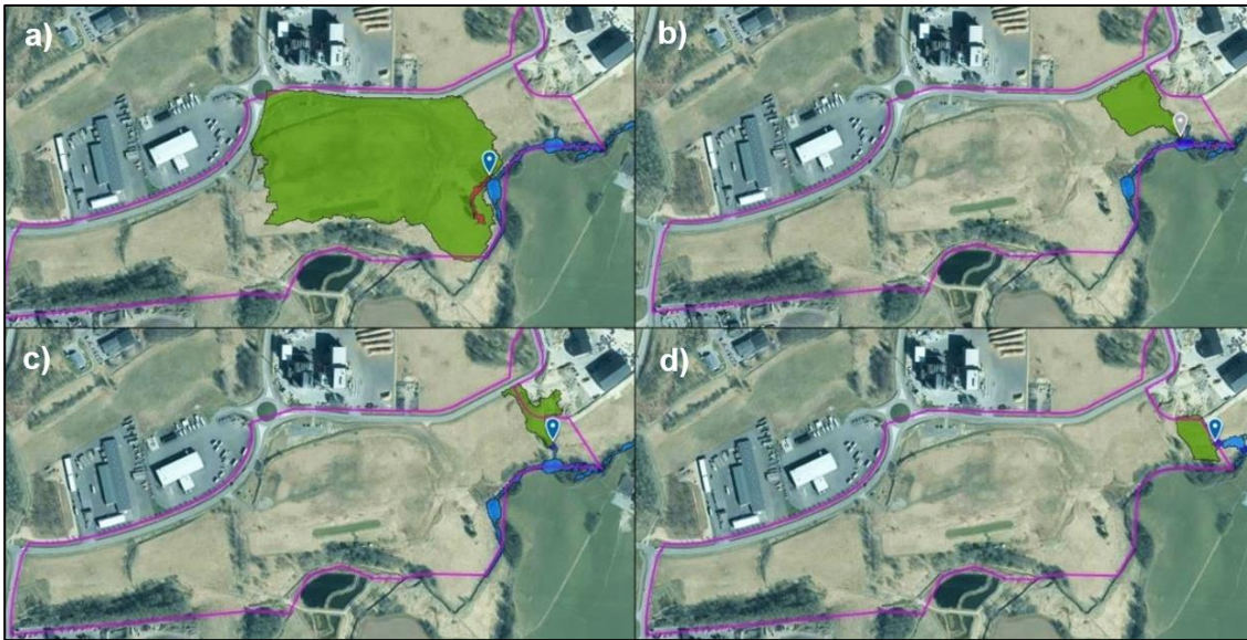
Figur 6. Planområdets östra avrinningsområden. Arealen på avrinningsområdet är; a) 10 ha, b) 2 ha, c) 0,5 ha, d) 0,5 ha. Källa: Lantmäteriet.
