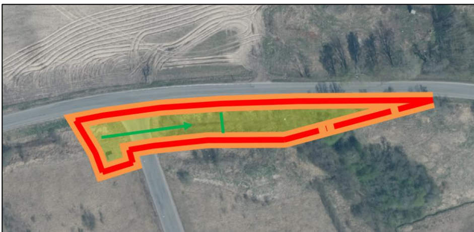
Figur 17. Översiktlig redovisning av fördröjning i befintligt dike. Befintligt dagvattentrumma redovisas med grön pil. Eventuell vall illustreras med grön linje.
