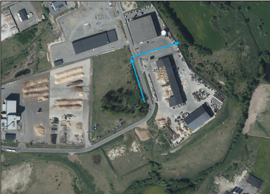
Figur 32. Ytlig flödesriktning när anslutande trummor går fulla. Efter fastighet värmeväxlaren 1 rinner vattnet genom naturmark till recipient.
