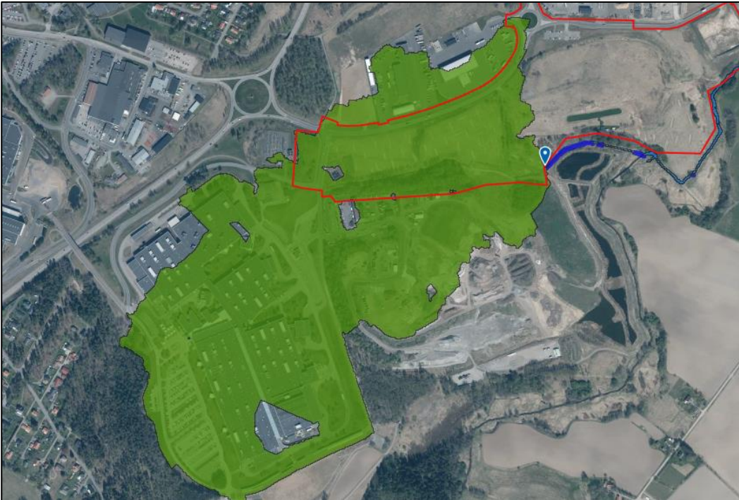
Figur 4. Arealen på avrinningsområdet är 43 ha (exklusive området inom planområdesgränsen. Grönt = Avrinningsområden. Blått = Möjlig utströmningsväg. Planområdets gränser är markerat med rött. Källa: Lantmäteriet (ortofoto daterad 2023-01-11) hämtat från SCALGO Live (2024).
