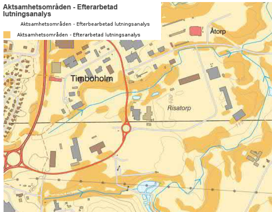
Figur 5. Urklipp ur SGU:s geologiska kartblad för förutsättningar för skred i finkorniga jordarter.
