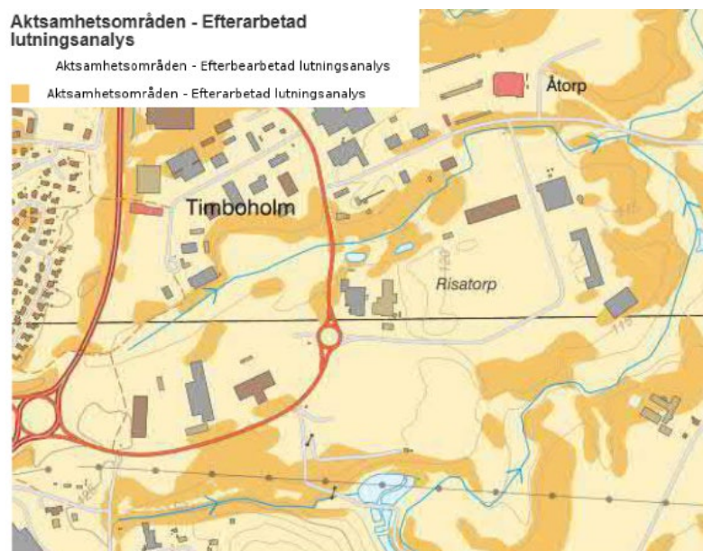
Urklipp ur SGU:s geologiska kartblad för förutsättningar för skred i finkorniga jordarter. Källa: Markteknisk undersökningsrapport, bilaga N
