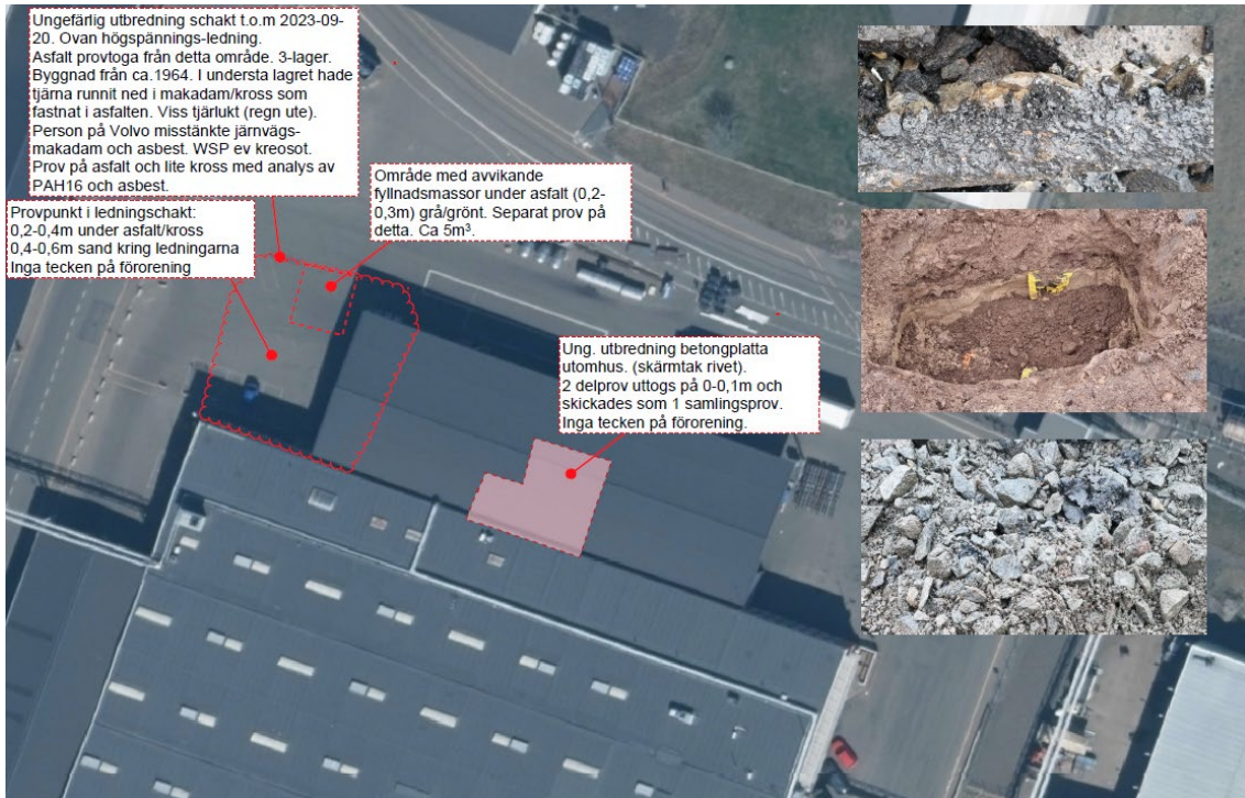
Figur 7. Lokalisering av provtagningar samt fältnoteringar norr om M1-hallen (WSP Bilaga E).
