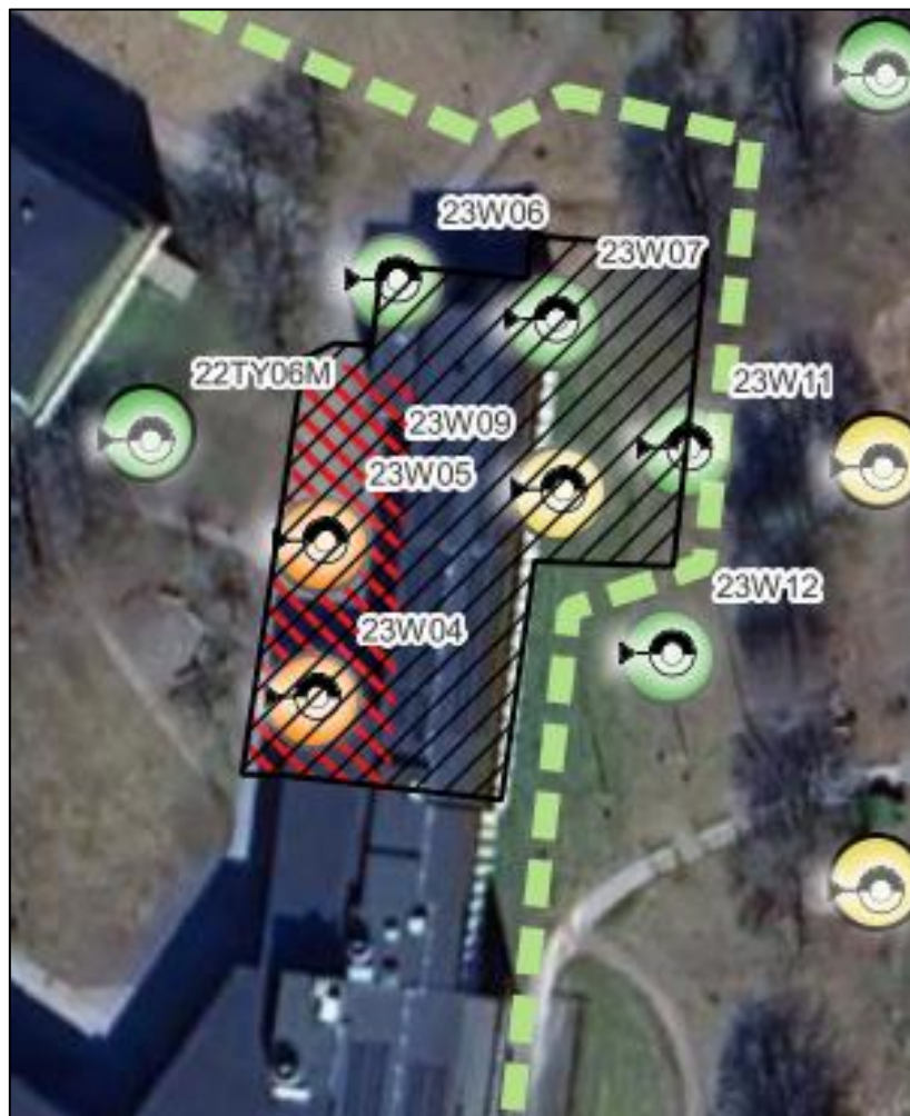
Figur 5. Uppskattat område med åtgärdsbehov.
