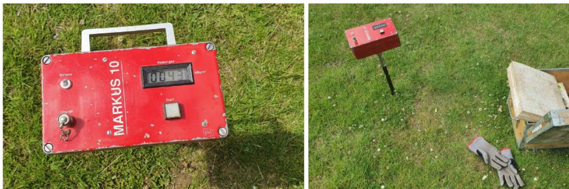
Figur 1 Till vänster: Avläsning av radonhalt efter utförd mätning, MP-3. Till Höger: Översikt över installerat instrument vid pågående mätning, MP-3.
