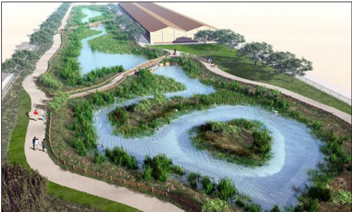
Figur 22. Exempel fördröjning och avledning i en långsmal dagvattenpark. (Our Weekly, 2017)
