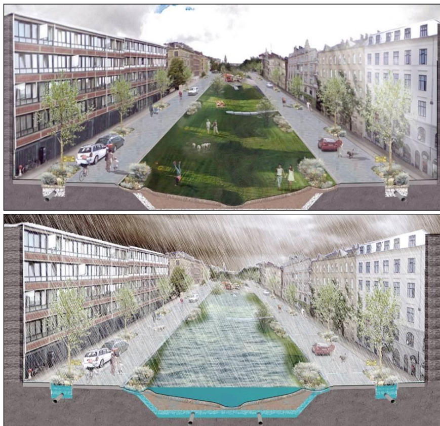
Figur 18. Exempel på översvämningssyta/avvattningsstråk i ett svackdike vid torr väderlek och extrem nederbörd (Copenhagize, 2016).
