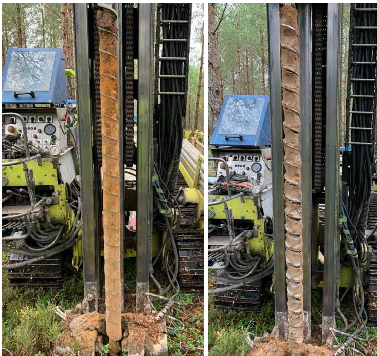
Figur 22. Jordprovtagning i punkt 21TY043M. Till vänster: 0-2 m u my. Till höger: 2-4 m u my. 2021-10-06.
