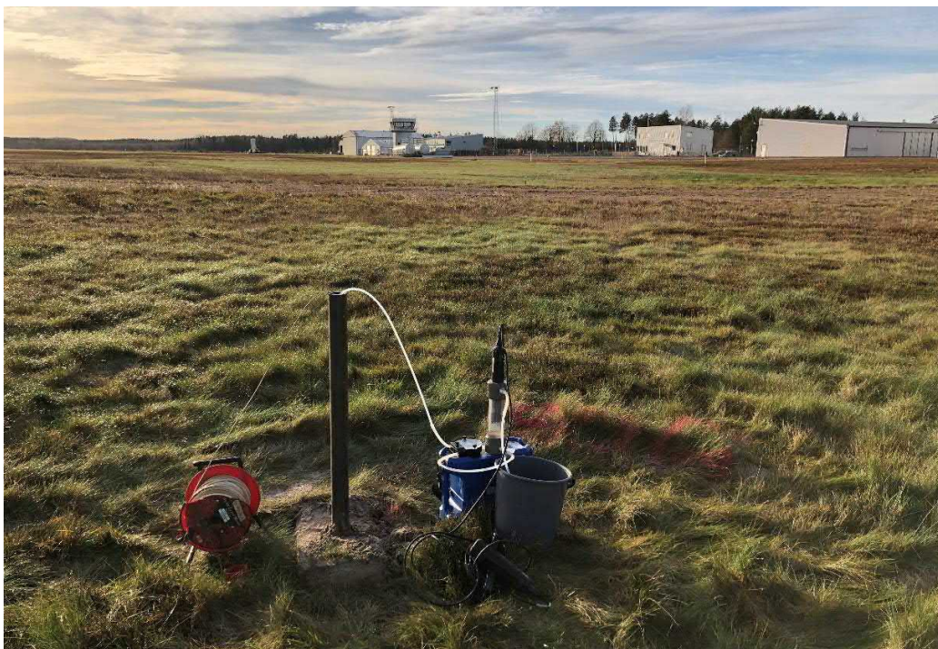
Figur 19. Djupt grundvattenrör i punkt 21TY080. Provtagning 2021-11-23.
