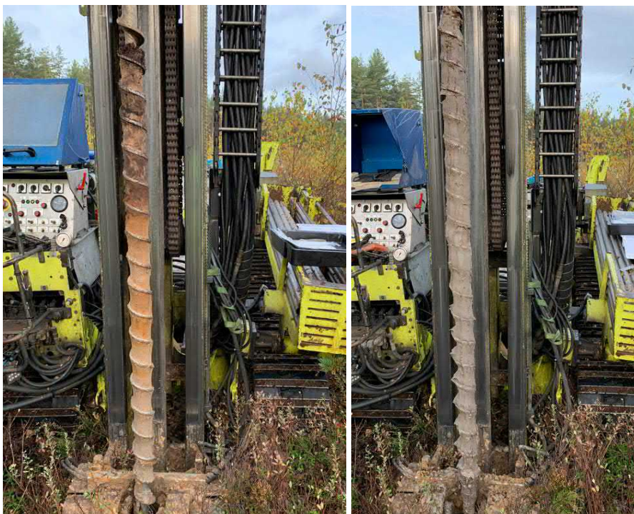
Figur 18. Jordprovtagning i punkt 21TY033M. Till vänster: 0-2 m u my. Till höger: 2-4 m u my. 2021-10-07.
