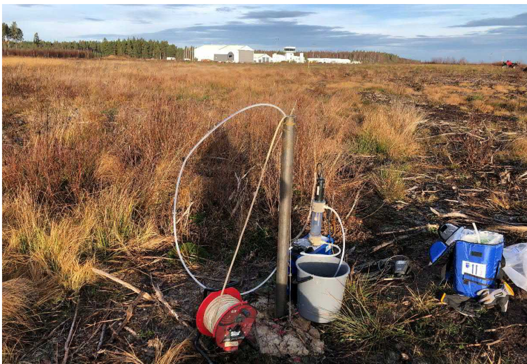
Figur 20. Djupt grundvattenrör i punkt 21TY082. Provtagning 2021-11-23.
