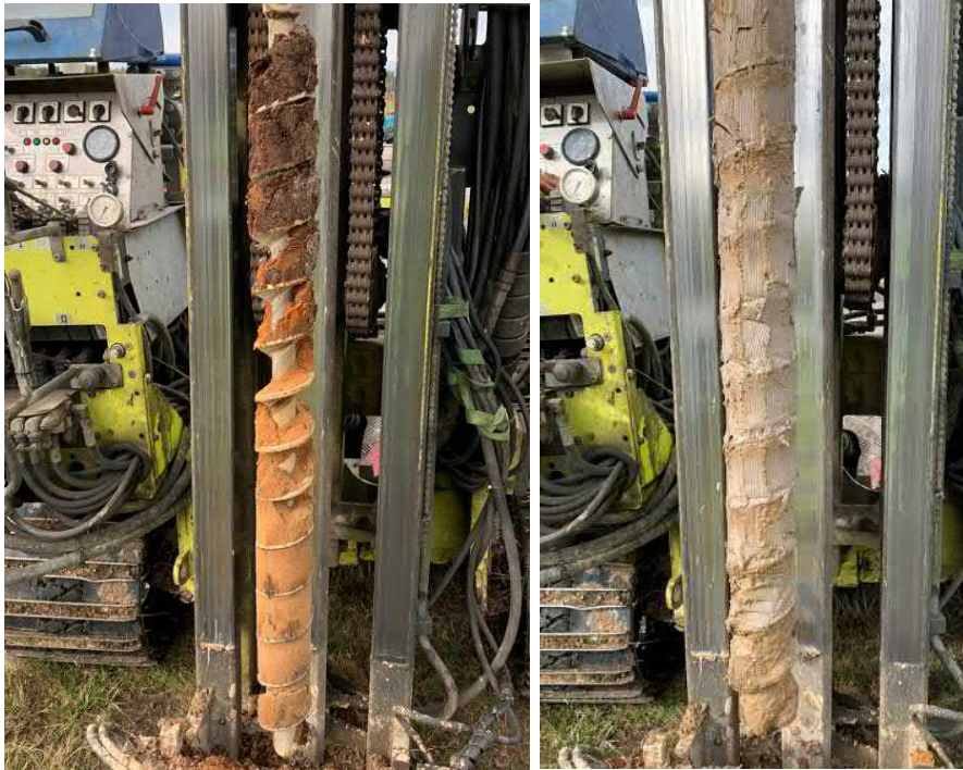
Figur 9. Jordprovtagning i punkt 21TY020M. Till vänster: 0-1 m u my. Till höger: 1,5-2 m u my. 2021-10-04.
