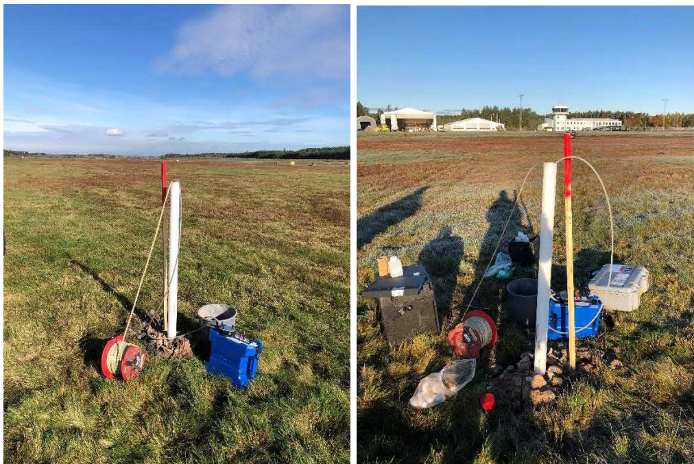
Figur 4. Grundvattenrör i punkt 21TY017. Punkten är belägen strax öster om flygplatsen. Till vänster: Renspumpning 2021-10-08. Till höger: Provtagning 2021-10-13.
