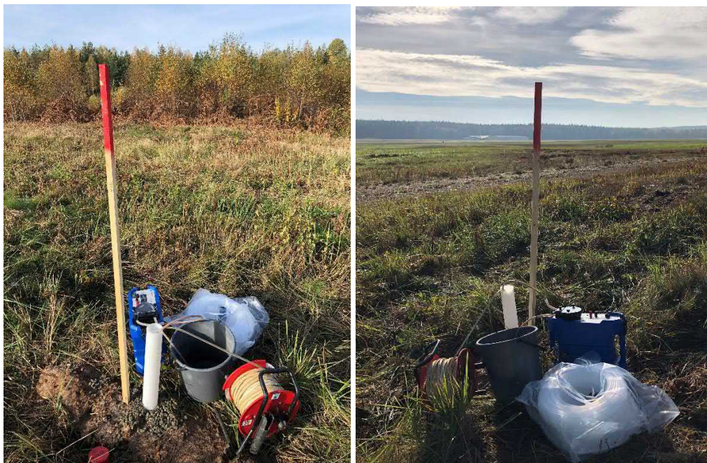
Figur 3. Grundvattenrör i punkt 21TY010. Segelflyg-förening är synlig längst bort på den högra bilden. Renspumpning 2021-10-08.
