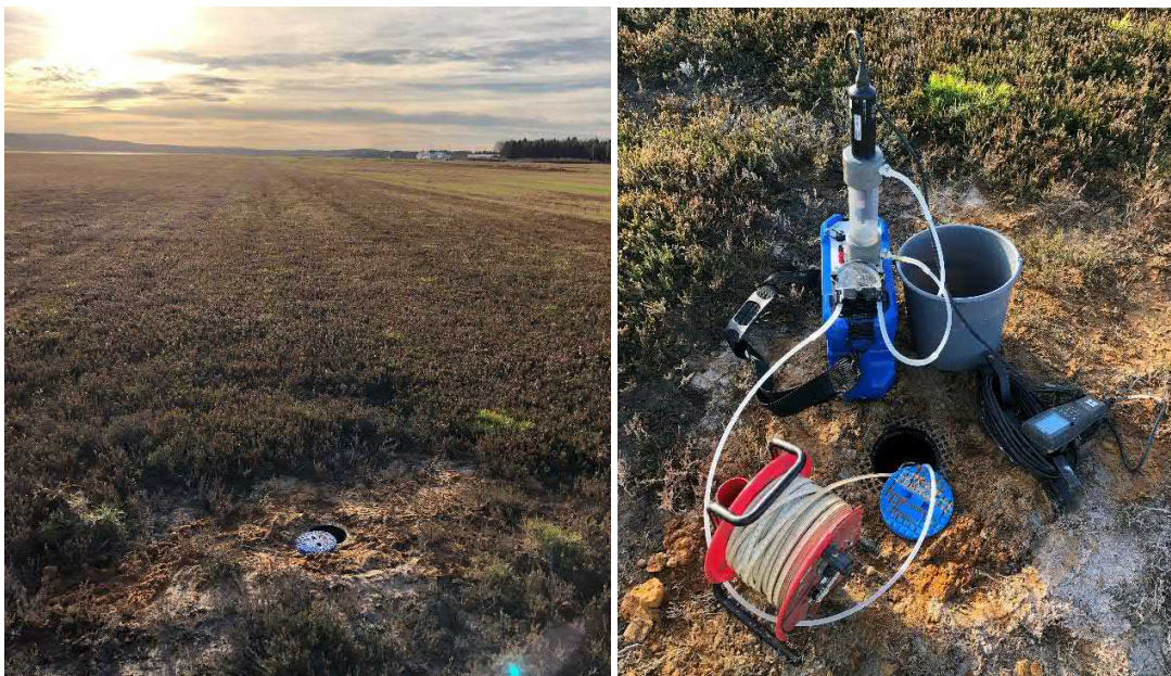
Figur 18. Djupt grundvattenrör i punkt 21TY079. Provtagning 2021-11-23.
