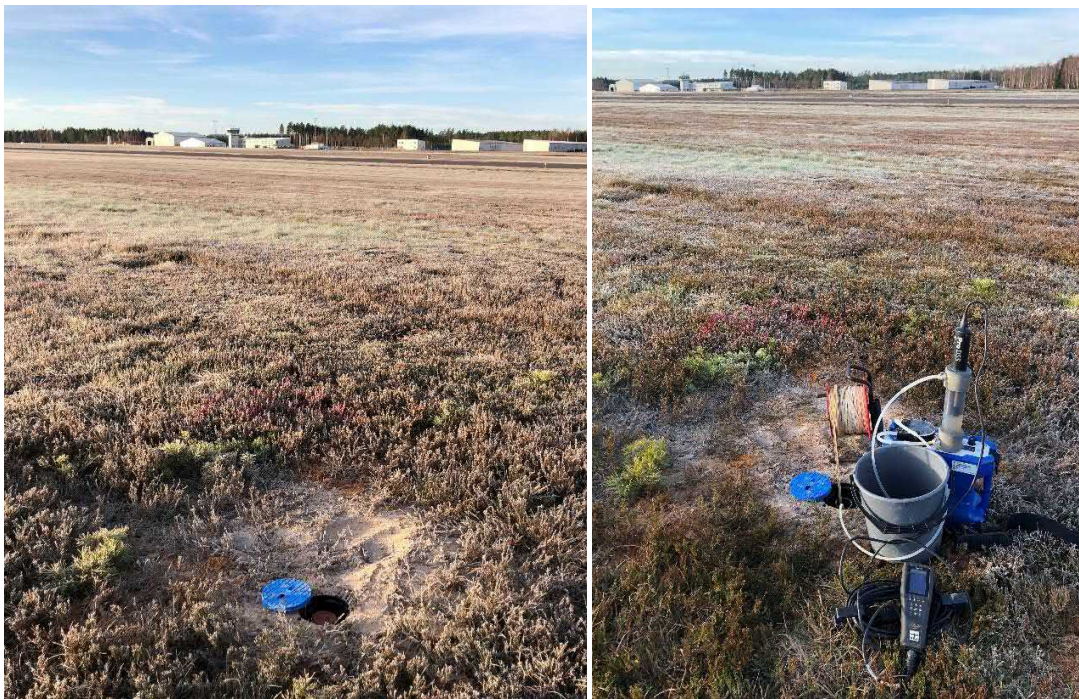
Figur 17. Djupt grundvattenrör i punkt 21TY074. Provtagning 2021-11-23.
