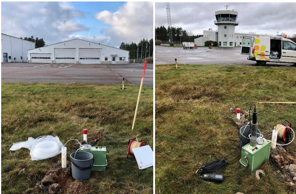
Figur 16. Grundvattenrör i punkt 21TY063 öster om terminalbyggnader. Till vänster: Renspumpning 2021-11-04. Till höger: Provtagning 2021-11-10.
