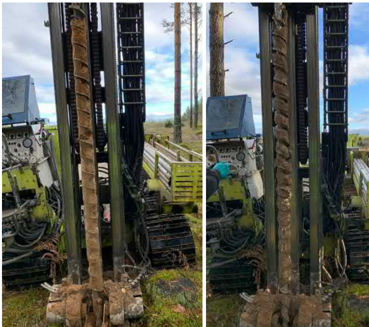
Figur 21. Jordprovtagning i punkt 21TY038M. Till vänster: 0-2 m u my. Till höger: 2-4 m u my. 2021-10-06.
